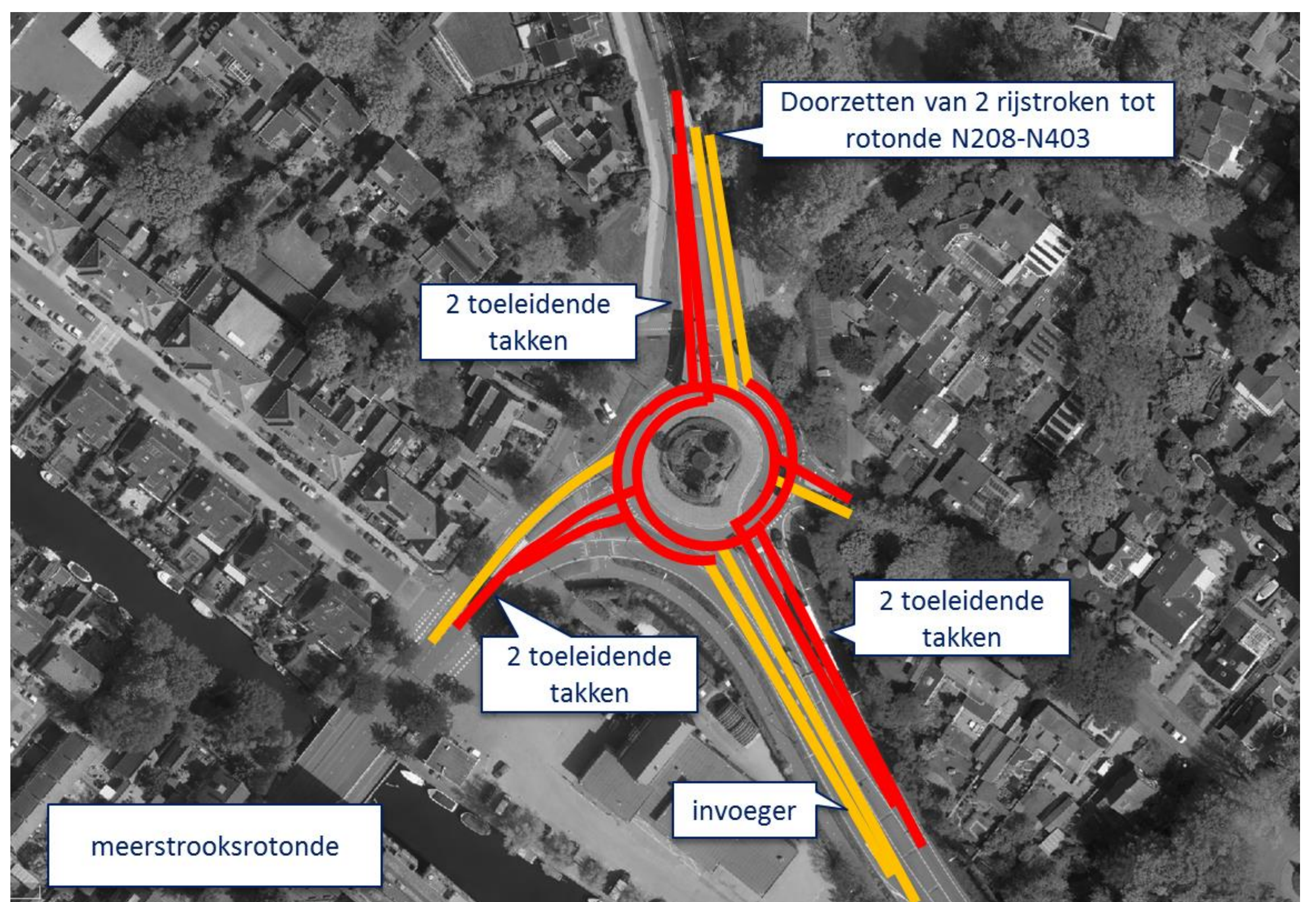
rotonde N208-Parklaan: huidig (links) en principe-oplossing (rechts)
